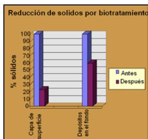
En pruebas realizadas reduce en un 77% el contenido en sólidos en superficie. Consigue una reducción de hasta el 40% de los sólidos en el fondo.
